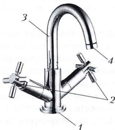
Рис. 87. Смеситель: 1 — корпус; 2 — вентильная головка; 3 — водоизливная трубка; 4 — аэратор
