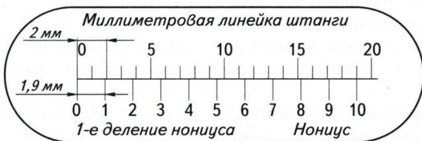
Рис. 64. Шкала штанги и нониус
