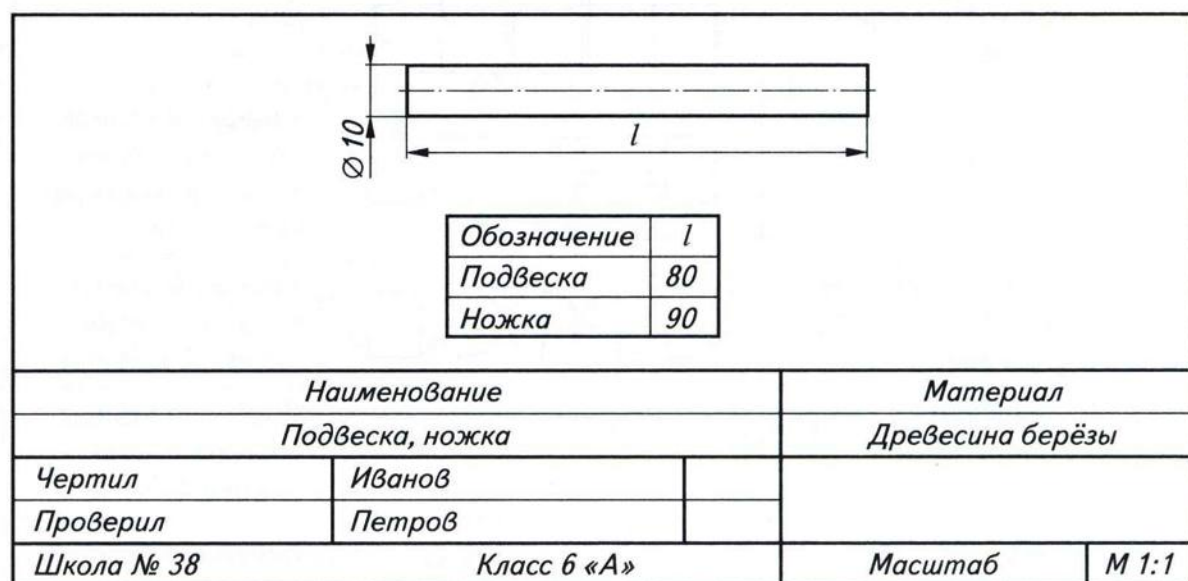
Рис. 55. Чертёж деталей «подвеска» и «ножка»
